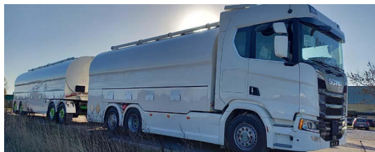
Figur 10. Tankbil med släp. Har en kapacitet om 20 \text{ m}^3 i dragbilens tank och 40 \text{ m}^3 i släpet. Error! Reference source not found.
