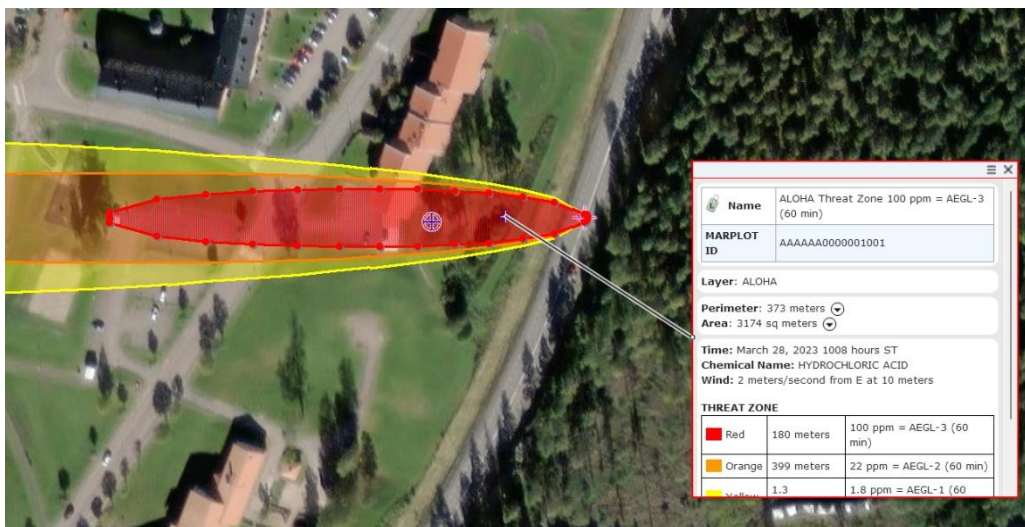
Figur 16. Bild från en av beräkningarna där utsläpp av salisyra beräknats.
