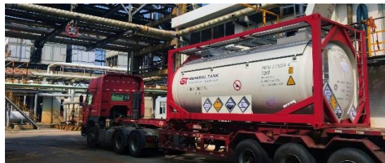
Figur 11. Tank för klor, T50. Har en volym om ca 38 \text{ m}^3 [10]
